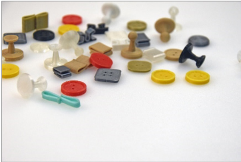
شكل (6) أشكال مختلفة من الأزرار المنفذ بتقنية (FDM) في البحث الحالي- تصوير الباحثات
