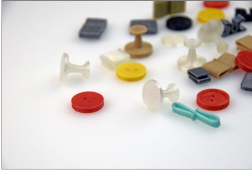
شكل (5) أشكال مختلفة من الأزرار المنفذ بتقنية (FDM) في البحث الحالي- تصوير الباحثات
